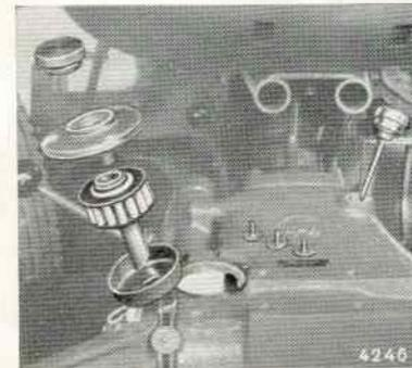
In den Kraftheberblock ist unterhalb der Öleinfüllschraube „O“, bzw. des Filterdeckels, ein Siebfeinfilter eingebaut. Dieses Filter besteht aus einem sternförmig gefalteten, feinem Drahtgewebe. **Nach den ersten 50 Betriebsstunden ist dieses Ölfilter unbedingt zu reinigen.** Zu diesem Zwecke wird das Einbaufilter nach Lösen der 3 Befestigungsschrauben herausgehoben. Der Schmutzsammeltopf ist um 90° zu drehen und
