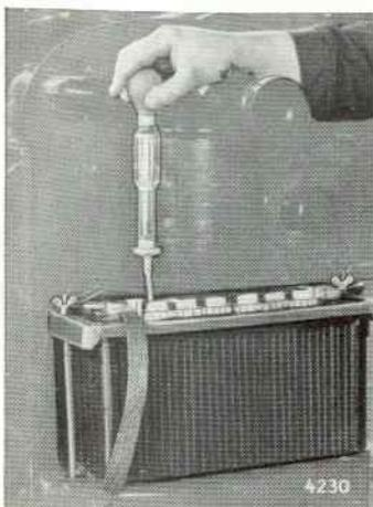
**Batterie:** Die elektrische Anlage muß immer in einem guten Zustand sein. Bei Arbeiten an der elektrischen Anlage sind zur Vermeidung von Kurzschlüssen die Batteriepole abzuklemmen. Die Flüssigkeitsverluste in den Batterien infolge Gasentwicklung und Verdunstung sind alle 100 Stunden durch destilliertes Wasser zu ergänzen, niemals durch Säure. Hierbei stets sauberes Gefäß verwenden.
